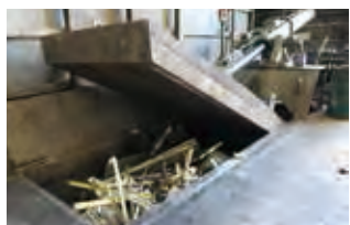
金属プレス機 選別後、金属くずを圧縮します。
