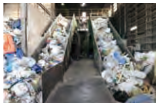
大型2ウェイライン 廃プラ、木くず、紙くずを破碎機へ送ります。
