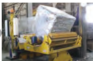
6面包装機・バンド巻き機 自動で6面にラッピングシートを巻きつけます。
