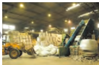
圧縮機 選別後圧縮します。
