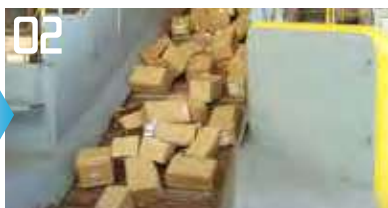
搬入された機密書類は、コンベアからパルパーへと運ばれます。
