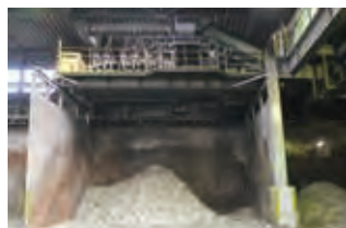
風力選別機 重さによって風力で振り分けます。
