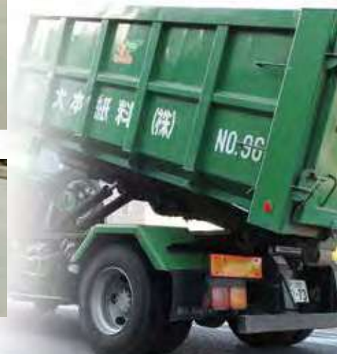
アミコンテナ (小) (幅1700×奥行2000×高さ1200mm)
